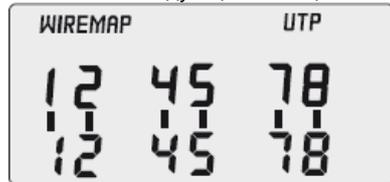
Результат при обрыве линий «3» и «6» кабеля RJ45
