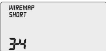
В этом случае для повторной проверки нажмите кнопку «TEST». Если этот результат повторится, для продолжения проверки устранили причину короткого замыкания.
