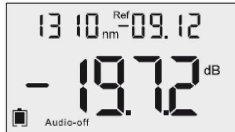
(7) При измерении потерь в волоконно-оптической линии связи необходимо сначала измерить первоначальный опорный уровень для источника света и измерителя мощности, как показано на следующем рисунке, прочесть его значение и сохранить его путем длительного нажатия кнопки
