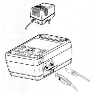
Рисунок 6. Использование сетевого адаптера.
