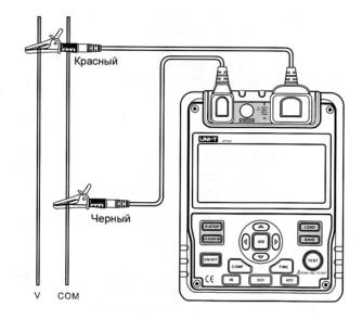
Рисунок 4. Измерение напряжения
