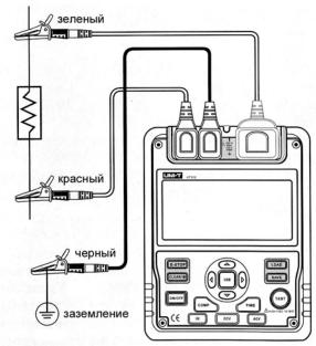
Рисунок 5. Измерение сопротивления изоляции
