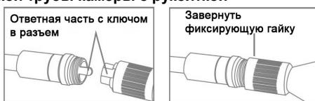
убедиться, что конец трубы с ключом выровнен относительно разъема рукоятки, затем с небольшим усилием соединить их. После правильного соединения завернуть по часовой стрелке фиксирующую гайку до упора.
